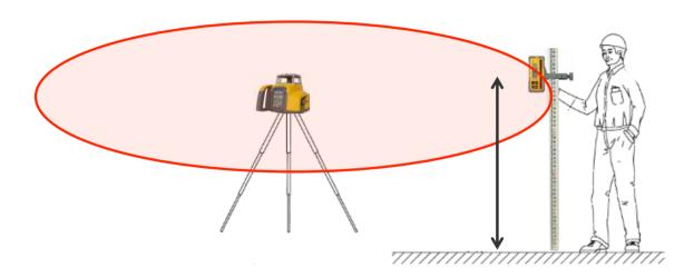
Les récepteurs laser sont utilisés pour niveler des coffrages, le béton et le sol.
